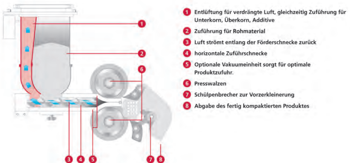
Optimierte Zuführung in der Combi-Vent-Feeder®-Technologie Darstellung am Beispiel einer WP 200 Pharma
