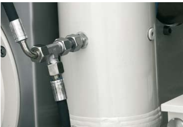
Steuer- und Regeltechnik in Verbindung mit zwei Hydraulikzylindern sorgen für den konstanten Walzenspalt und damit die Güte der Schülpe.
