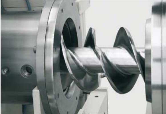
Alexanderwerk verfügt über eine jahrzehntelange Erfahrung im Bau von Walzenpressen, die sich in der PP-Serie widerspiegelt: alle Module des PP350 sind leicht zugänglich. Das Bild zeigt das Ausfahren der speisenden Schnecke (ohne Spezialwerkzeug).
