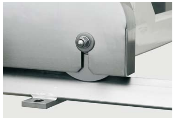
Über ein Schienensystem lässt sich die Zuführeinheit – nach dem Lösen der Verschraubung – leicht von der Kompaktiereinheit wegfahren.
